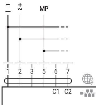
PoE avec BACnet/IP / Modbus TCP
