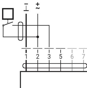
Connexion avec capteur actif
