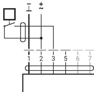
Connexion avec capteur actif
