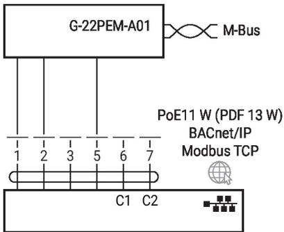
M-Bus avec convertisseur en mode parallèle avec BACnet/IP/ Modbus TCP
