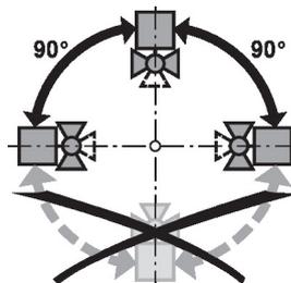
**Installation dans la conduite de retour** Installation dans la conduite de retour recommandée.
