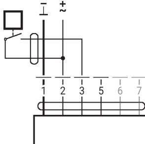
Connexion avec capteur actif
