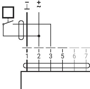
Connexion avec capteur actif
