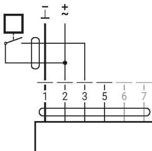
Connexion avec capteur actif
