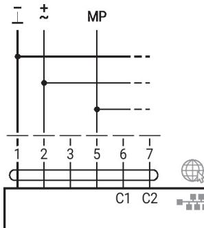
MP-Bus par un raccordement à 2 fils, alimentation locale
