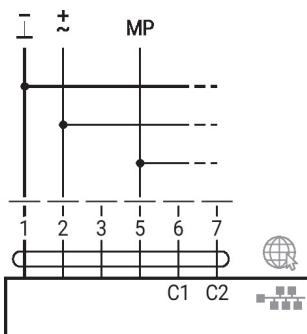
PoE avec BACnet/IP / Modbus TCP
