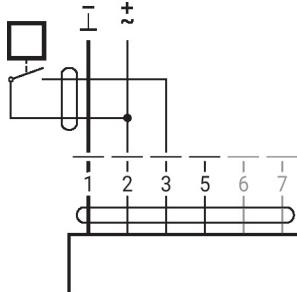
Connexion avec capteur actif
