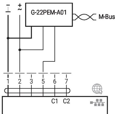
M-Bus avec convertisseur en mode parallèle avec PoE avec BACnet/IP/ Modbus TCP
