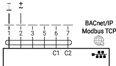
MP-Bus, alimentation par un raccordement à 3 fils
