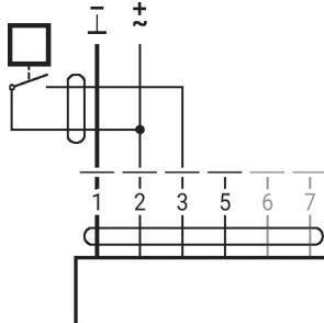
Connexion avec capteur actif
