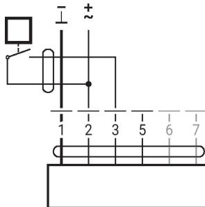
Connexion avec capteur actif
