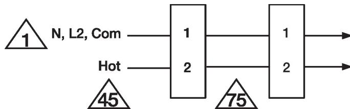
Câblage du contact auxiliaire
