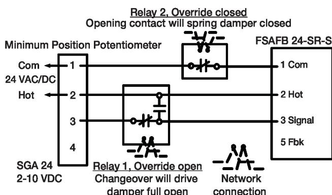
Pour convertir le FSAFB24-BAL, utiliser le diagramme ci-dessus.
