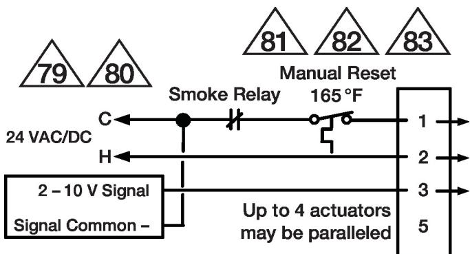
Pour convertir le FSAFB24-BAL, utiliser le diagramme ci-dessus.
