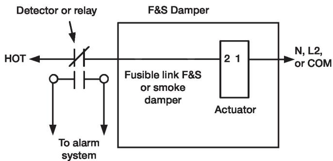
Câblage en parallèle des servomoteurs
