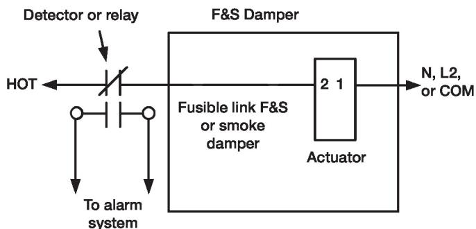
Câblage en parallèle des servomoteurs
