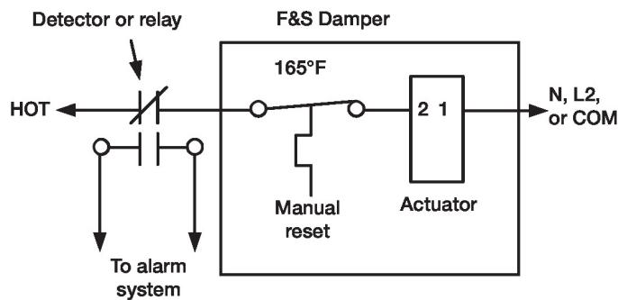
Câblage en parallèle des servomoteurs
