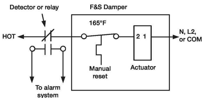
Câblage en parallèle des servomoteurs
