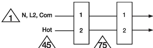
Câblage en parallèle des servomoteurs
