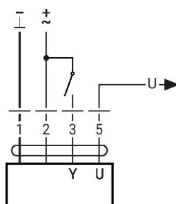
Commande de surpassement et limitation de positionnement avec interrupteur rotatif AC 24 V
