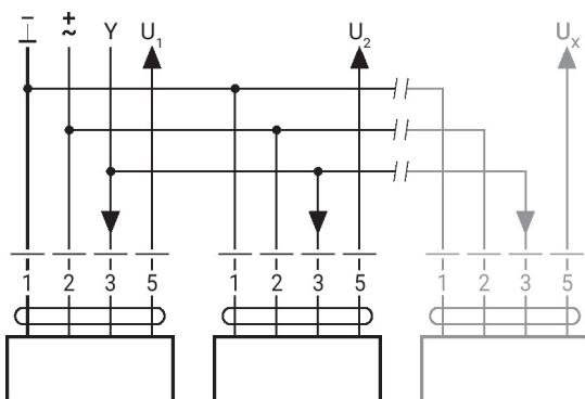
8 servomoteurs maximum peuvent être raccordés en parallèle
