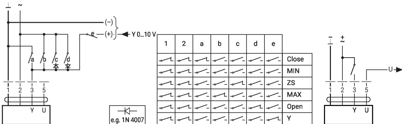
Commande de surpassement et limitation de positionnement avec interrupteur rotatif AC 24 V
