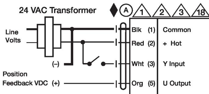
Transformateur à commande à virgule flottante AC 24 V (AC uniquement)
