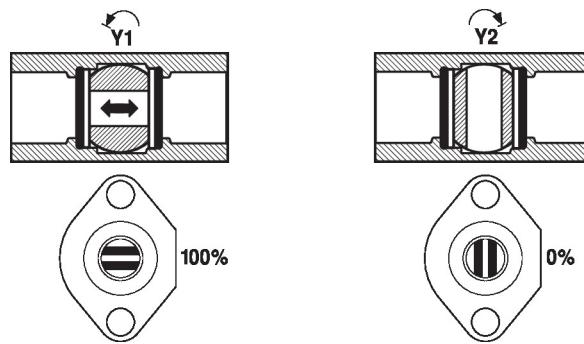
**Réglage de débit** L'angle de rotation du servomoteur est réglable, à l'aide d'une pince, par incrément de 2.5°. Il sert à régler la valeur Kvs (débit maximal admissible du robinet).
