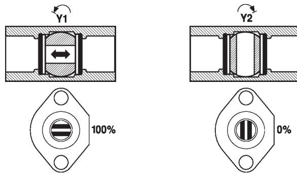
**Réglage de débit** L'angle de rotation du servomoteur est réglable, à l'aide d'une pince, par incrément de 2.5°. Il sert à régler la valeur kvs (débit maximal admissible du robinet). Retirer la butée de fin de course encliquetable et la placer à la position désirée. Après chaque changement de réglage du débit à l'aide de la butée de fin de course encliquetable, une adaptation doit être déclenchée sur les servomoteurs modulants.
