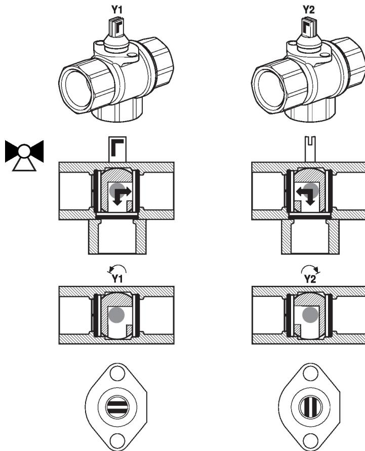
**Réglage de débit** Au niveau du servomoteur, la butée de fin de course encliquetable doit être retirée afin d'obtenir l'angle de rotation de 90° nécessaire à la fonctionnalité de commutation.
