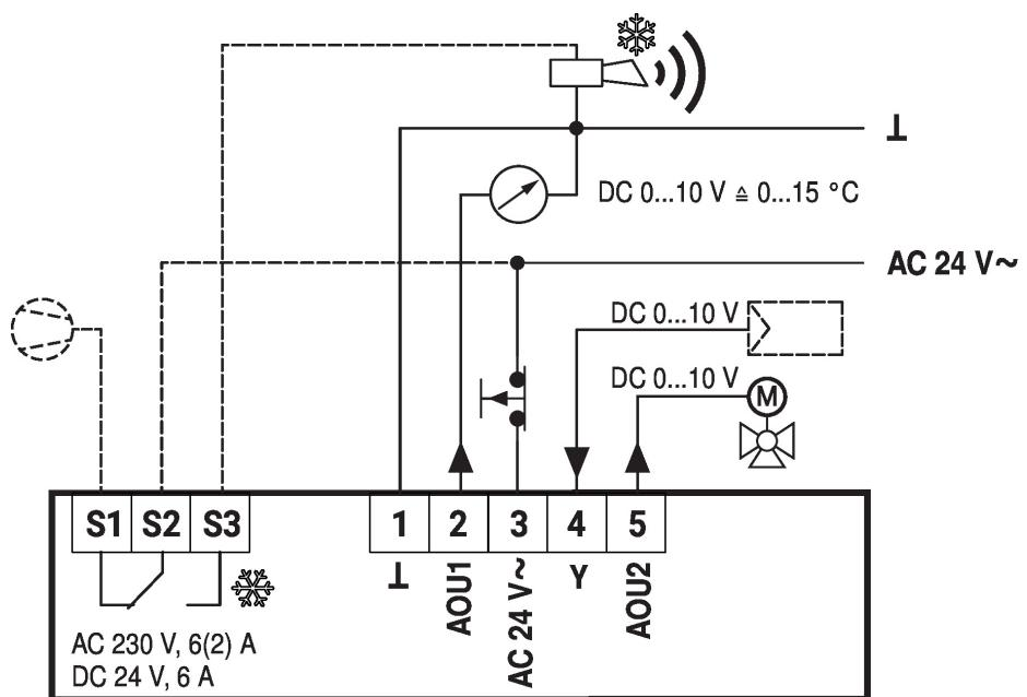
Si le capillaire fuit, l'interrupteur commute en position givré.
