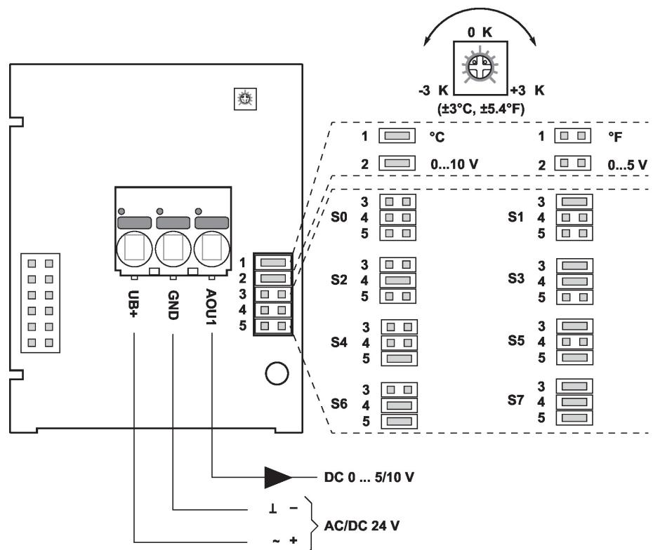
Les plages de mesure suivantes peuvent être réglées à l'aide des paramètres du cavalier :
