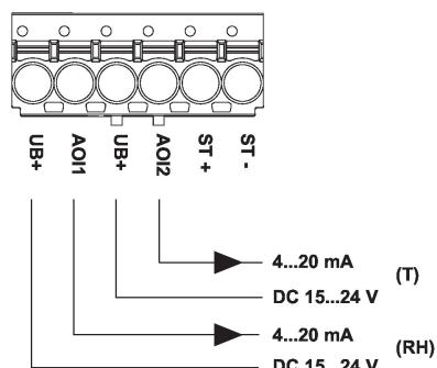
Les valeurs de température correctes sont uniquement disponibles lorsque la sortie d'humidité AOI1 et les deux entrées UB + sont connectées.
