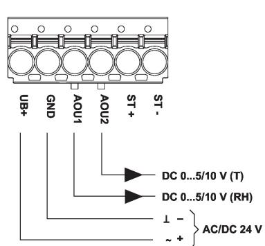
Les plages de mesure suivantes peuvent être réglées à l'aide des paramètres du cavalier :
