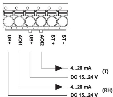
Les valeurs de température correctes sont uniquement disponibles lorsque la sortie d'humidité AO1 et les deux entrées UB + sont connectées.
