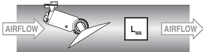
**Niveau de puissance sonore LWA** Niveau de puissance sonore avec évaluation A, y compris la correction de la réflexion de sortie LWA
