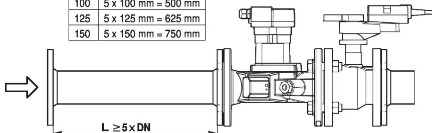
**Installation fractionnée** La combinaison vanne/servomoteur peut être montée séparément du capteur de débit. Le sens du débit des deux composants doit être respecté.
