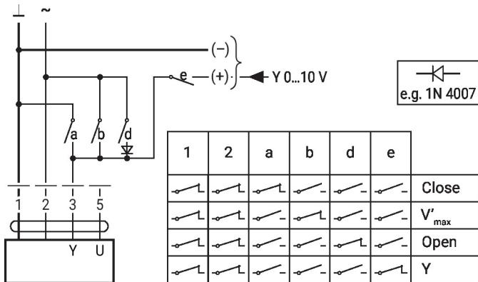
Commande forcée et limitation avec alimentation DC 24 V par des contacts relais
