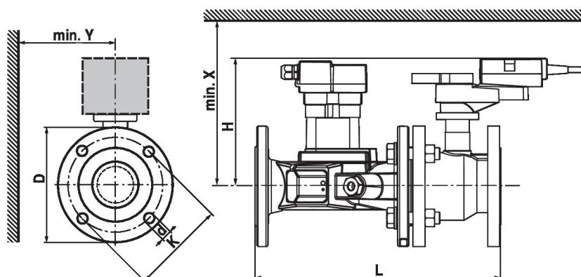
Si Y < 180 mm, la rallonge de la manivelle à main doit être démontée si nécessaire.
