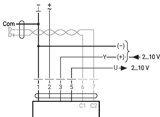
BACnet MS/TP / Modbus RTU
