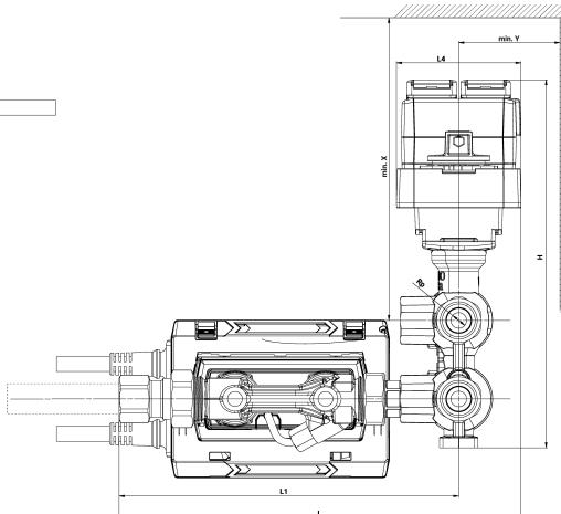
Vous pouvez également connecter le capteur de débit et le composant de conduit au port 3 (voir les notes d'installation).
