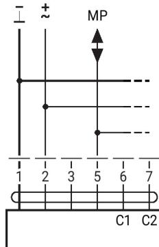
MP-Bus, via un raccordement à 2 fils, alimentation locale
