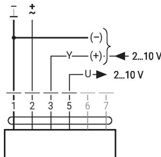
Modbus RTU / BACnet MS/TP avec point de consigne analogique
