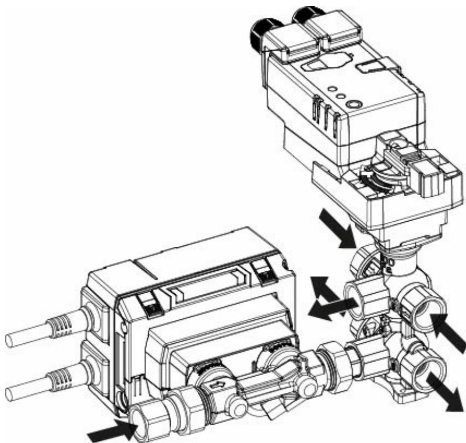
Variante avec accessoires P2P..-1GE pour une hauteur d'installation minimale (135 mm)
