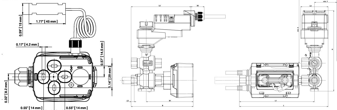
Vous pouvez également connecter le capteur de débit et le composant de conduit au port 3 (voir les notes d'installation).
