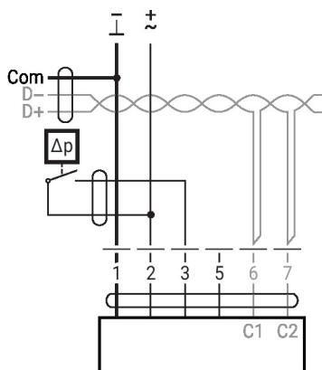
Exigences relatives au contact de commutation : le contact de commutation doit pouvoir commuter un courant de 16 mA à 24 V avec précision.
