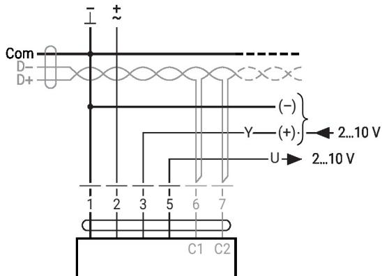
MP-Bus, alimentation via un raccordement à 3 fils
