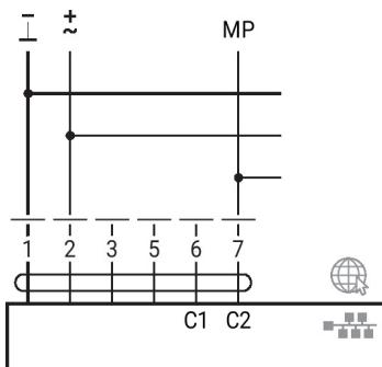
MP-Bus, via un raccordement à 2 fils, alimentation locale
