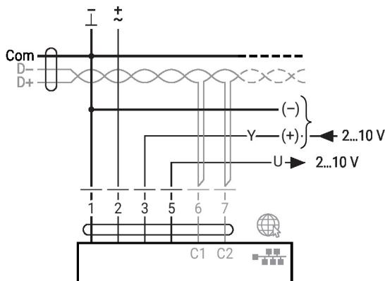
BACnet/IP / Modbus TCP avec point de consigne analogique (mode hybride)
