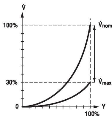
**Limite de mesure** Compte tenu de la vitesse d'écoulement très faible dans la phase d'ouverture, ce n'est plus mesurable par le capteur avec la tolérance requise. Cette plage sera masquée électroniquement.
