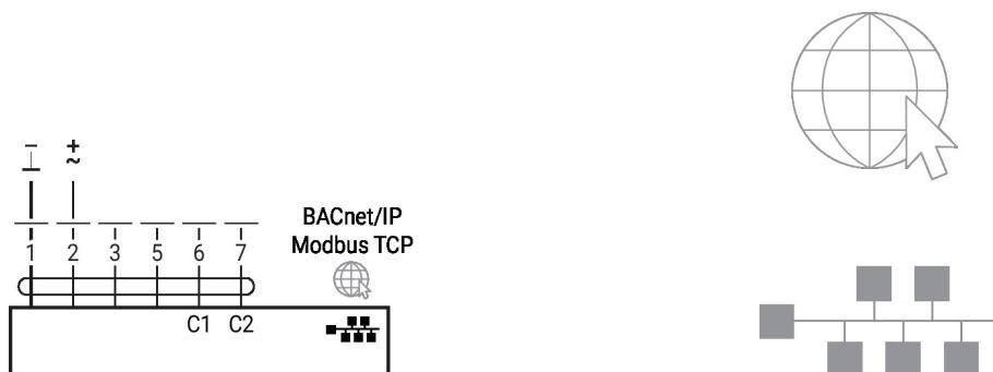
Raccordement en option via RJ45 (raccordement direct d'un ordinateur/connexion via l'intranet ou Internet) pour accéder au serveur Web intégré
