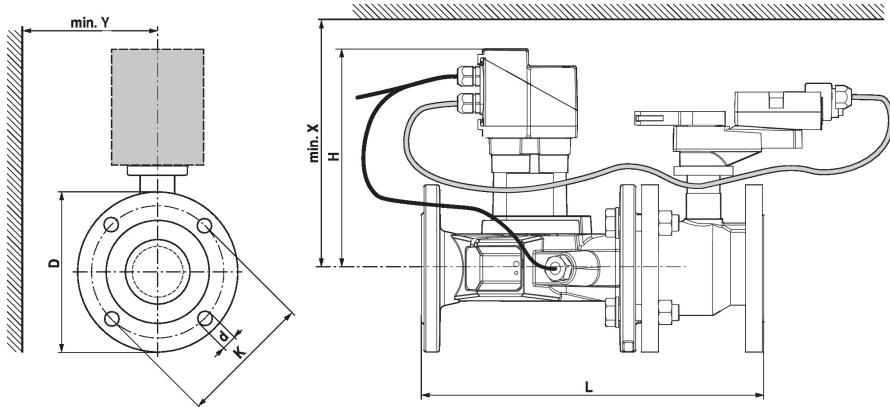
Si Y < 180 mm, la rallonge de la manivelle à main doit être démontée si nécessaire.
