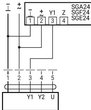
Limitation minimale avec positionneur SG.
