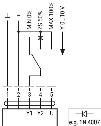
Commande à distance 0...100% avec positionneur SG.
