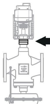
Tourner la bague dans le sens anti-horaire de sa position la plus basse pour augmenter le débit.
