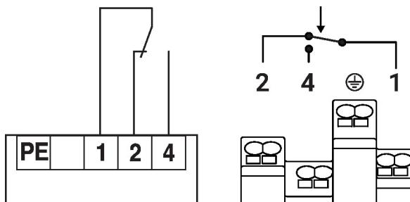
Si le tube présente une fuite, le circuit électrique 1-4 est fermé en permanence. Le déverrouillage n'est plus possible.
