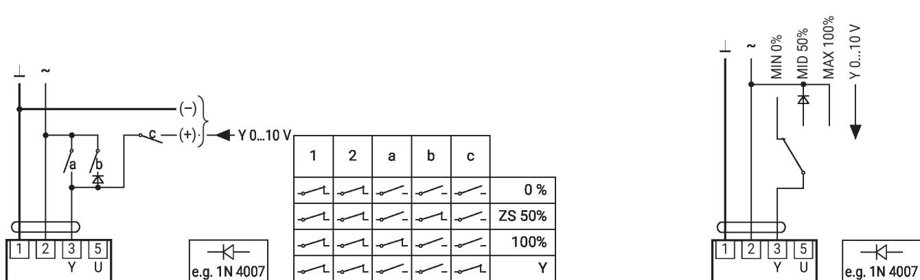
Commande à distance 0...100% avec positionneur SG.
