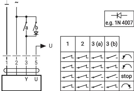
Commande forcée et limitation avec alimentation AC 24 V par un commutateur rotatif
