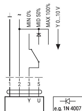
**Autres installations électriques****Câblage avec valeurs basiques (fonctionnement classique)**
