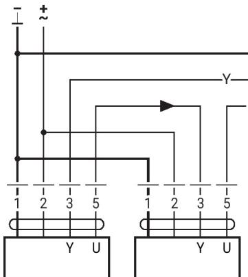
**Commande avec 4 - 20 mA via résistance externe**
