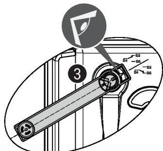
Pour le réglage de la position commutateur contact auxiliaire, effectuer les ① à ④ successivement.
