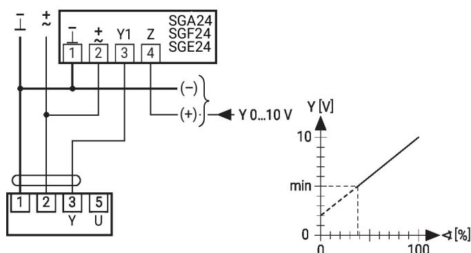
**Autres installations électriques****Câblage avec valeurs basiques (fonctionnement classique)**
