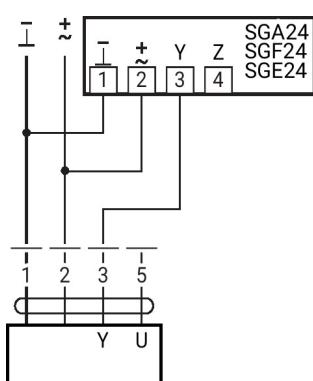
Limitation minimale avec positionneur SG.
