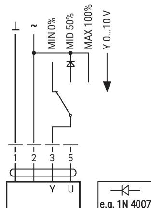
Commande à distance 0...100% avec positionneur SG.
