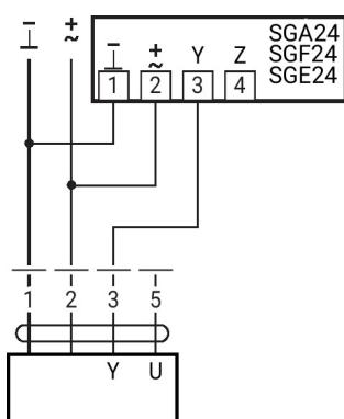
Limitation minimale avec positionneur SG.
