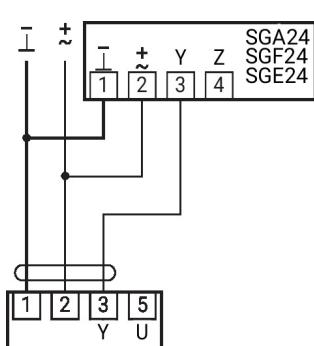
Limitation minimale avec positionneur SG.
