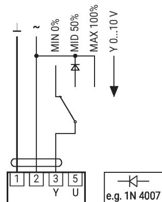
Commande à distance 0...100% avec positionneur SG.
