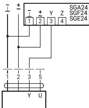
Limitation minimale avec positionneur SG.
