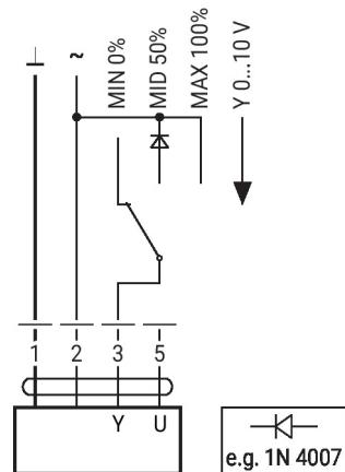
Commande à distance 0...100% avec positionneur SG.
