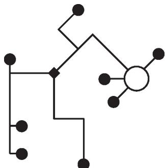
Il n'y a pas de restrictions dans la façon de câbler (en étoile, en boucle, « arbre », ou formes mixtes admises).
