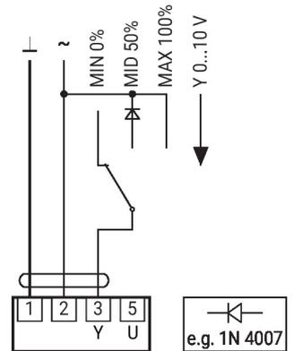
Commande à distance 0...100% avec positionneur SG.
