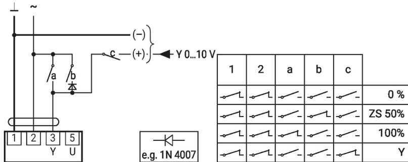
Commande forcée avec commutateur rotatif AC 24 V
