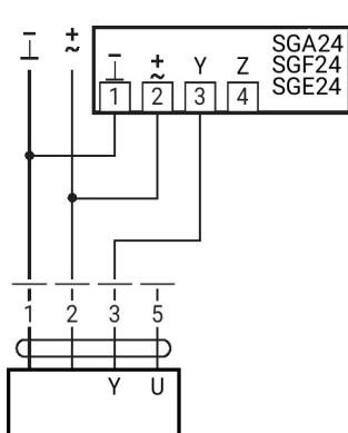
Limitation minimale avec positionneur SG.
