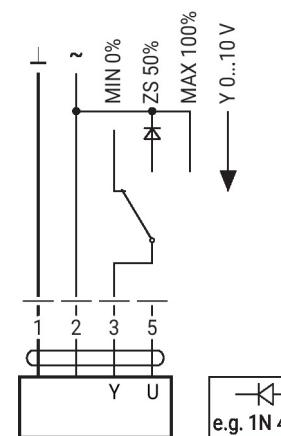
Commande à distance 0...100% avec positionneur SG.
