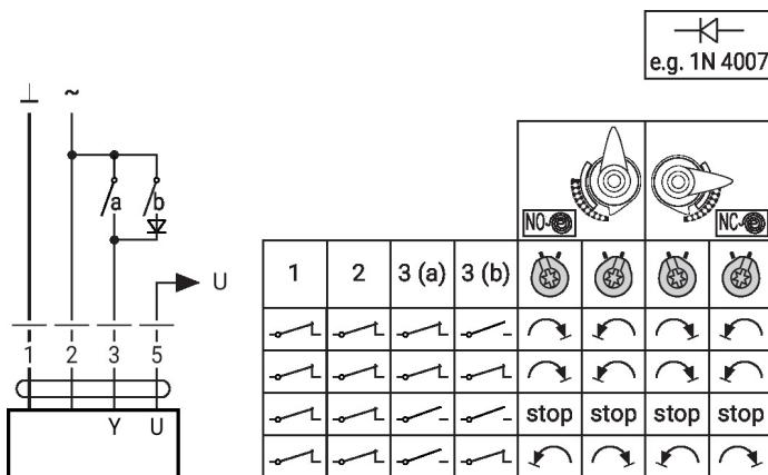
Commande forcée et limitation avec alimentation AC 24 V par un commutateur rotatif
