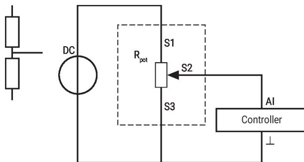
Si le potentiomètre est principalement utilisé dans la même petite plage d'angles, nous recommandons de le raccorder comme répartiteur de tension.
