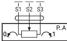
Recommandation : raccordement comme diviseur de tension
