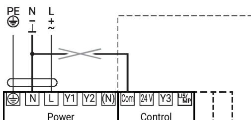
L'alimentation électrique ne doit pas être raccordée aux bornes de commande !
