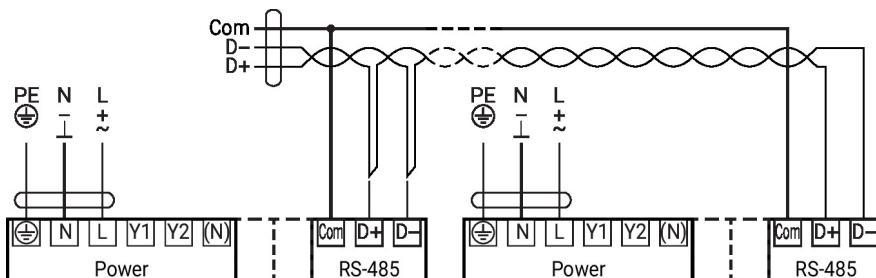
Raccordement BACnet MS/TP / Modbus RTU avec point de consigne analogique (mode hybride)
