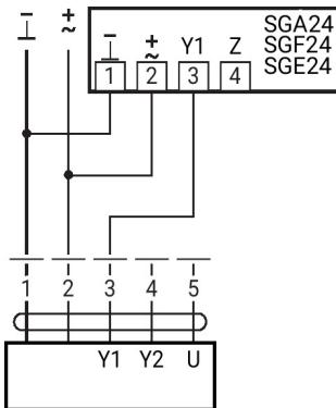
Limitation minimale avec positionneur SG.
