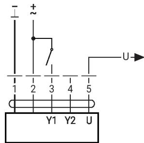
Commande forcée et limitation avec alimentation AC 24 V par un commutateur rotatif
